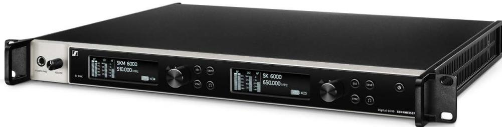
Le récepteur numérique à 2 canaux fonctionne sur une gamme de commutation de 244 MHz (470 – 714 MHz), couverte par trois versions d'émetteurs. Jusqu'à huit EM 6000 peuvent être raccordés en cascade sans splitter d'antenne supplémentaire, une seule paire d'antennes suffisant pour un système multicanal.
